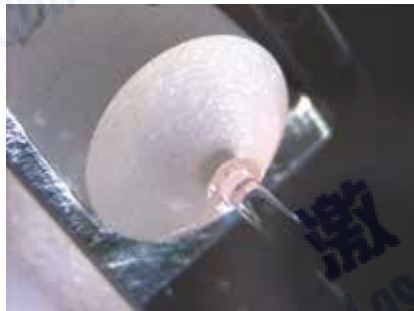
图3: 端帽(左上)熔接到光纤上(右下)。
