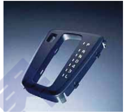
图2: 一个用于汽车上的塑料成型元件, 其上已经镀有涂层。多余的涂层通过激光去除, 使变速杆旁的字母显现出来。
